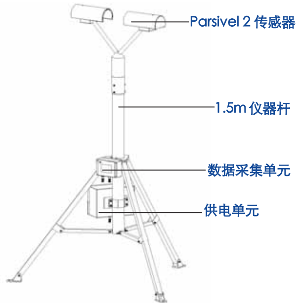
☑ PS32-RI 雨滴谱监测仪功能示意图
